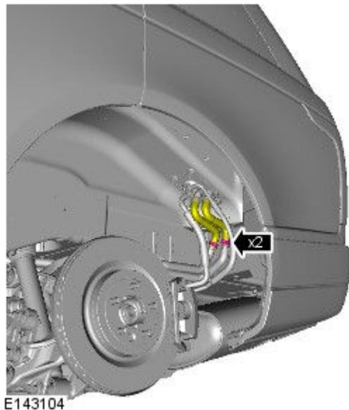
14. 重复执行至加注部分中的步骤 1，共三次，在前两次排放后用清洁的水加注冷却系统。在第三次重新加注时，利用适当的测量工具，确保冷却系统维持在 50% 混合液所需的冷却液容量。
