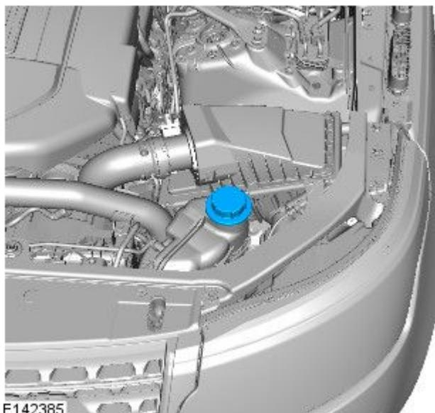
21. 运行发动机，直至恒温器打开，前、后面部出风口释放出热空气。
